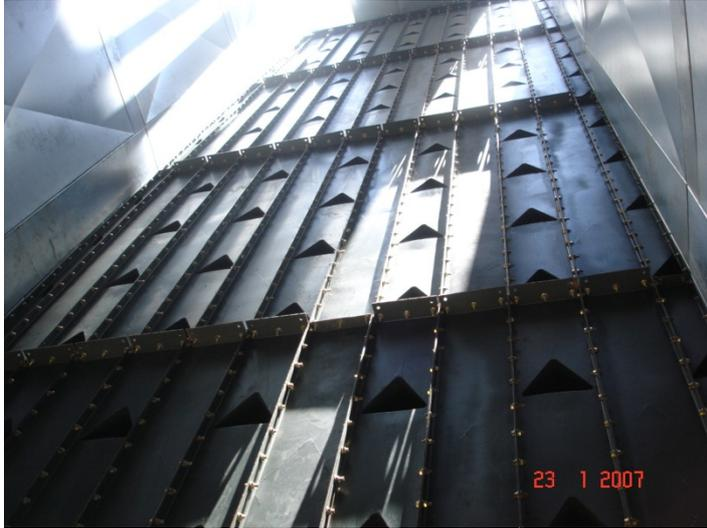
*A coluna de secagem é composta por dutos abertos e fechados dispostos para formar colunas menores por onde os grãos passam durante o processo de secagem. Estes dutos podem ser fabricados com aço preto com revestimento por tinta cromato*
