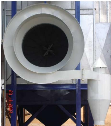
*O depurador de ar trabalha com a energia cinética gerada pelo ventilador axial fazendo com o ar saturado seja centrifugado dentro do corpo do depurador, com isso o material particulado é*
